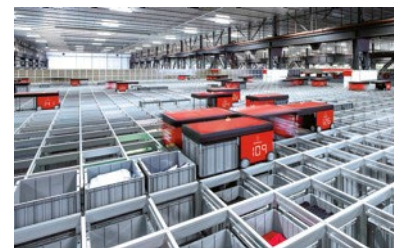
ロボットストレージシステム
